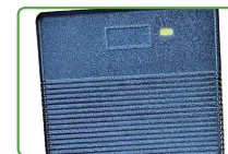
La batterie est pleine
